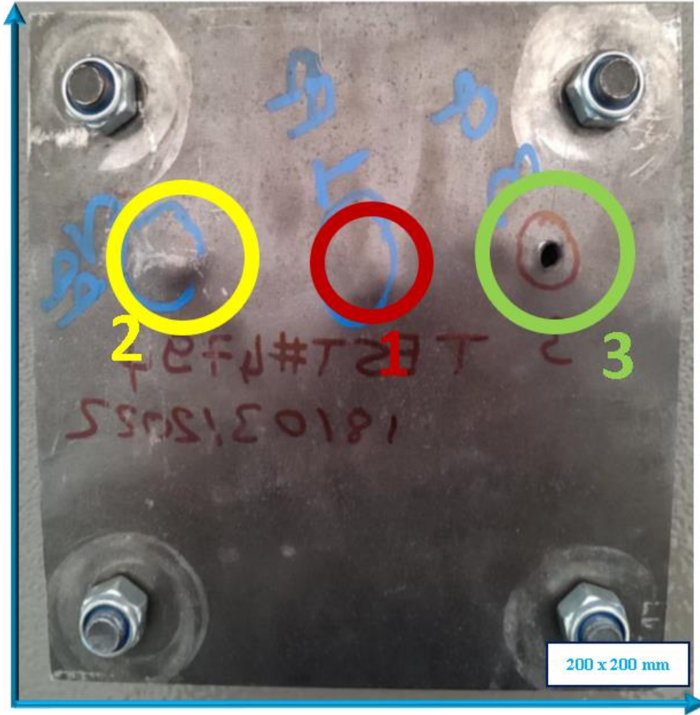
Şekil 8.10. Birinci zırh konfigürasyonu arkadan atış sonrası görünümü
