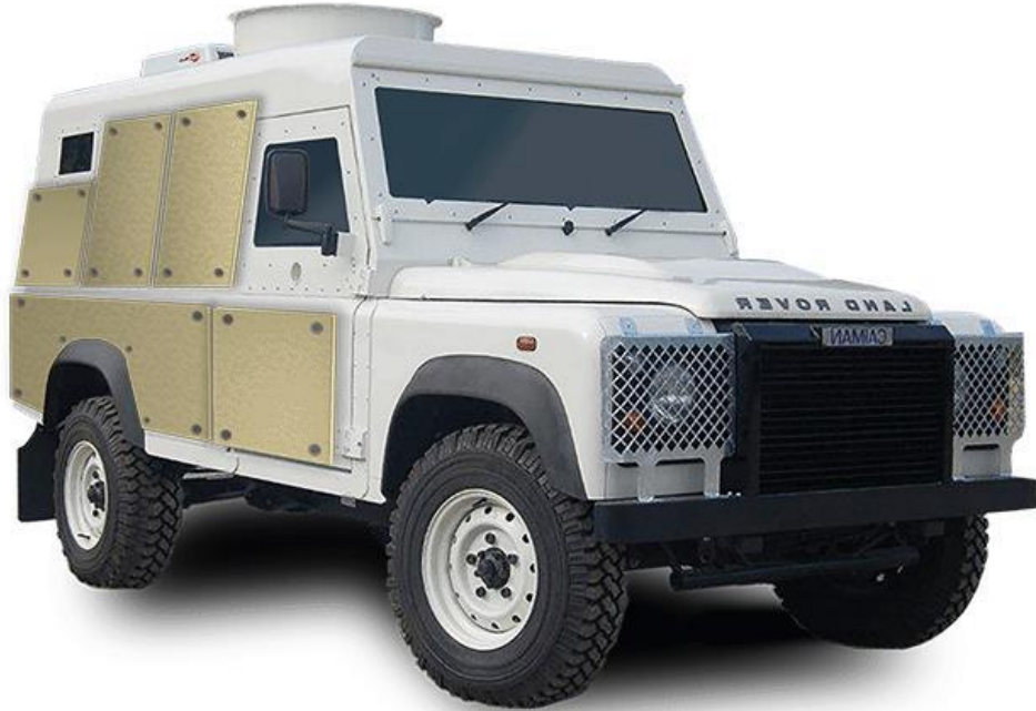
Şekil 1.2. Aplike zırh sisteminin araç üzerindeki görünümü
