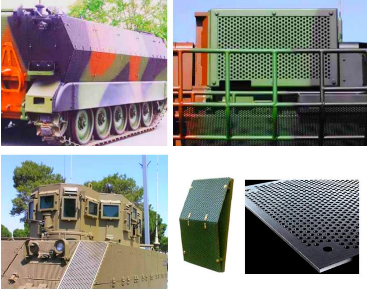
Şekil 3.1. Perfore zırh plakalarının endüstriyel uygulamaları
