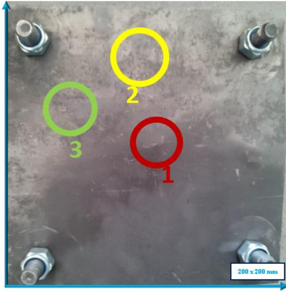
Şekil 8.14. Üçüncü zırh konfigürasyonu arkadan atış sonrası görünümü
